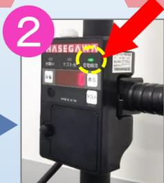
2 接地マグネットを側面金属板(テストプレート)に取り付け。接地線良ランプ点灯確認。
