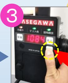
3 テストスイッチを押して電圧確認。
